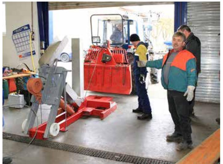
**Forstseilwinden müssen regelmäßig geprüft werden. Die Anforderung einer mobilen Station lohnt sich, wenn mehrere Winden zu prüfen sind.**
