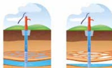
das Wasser um zum Rohr zu gelangen. Pumpen wir nun zu schnell dann erzeugen wir Trockenheit um das Rohr. Je schneller wir dies nun tun umso größer wird diese trockene Fläche.
