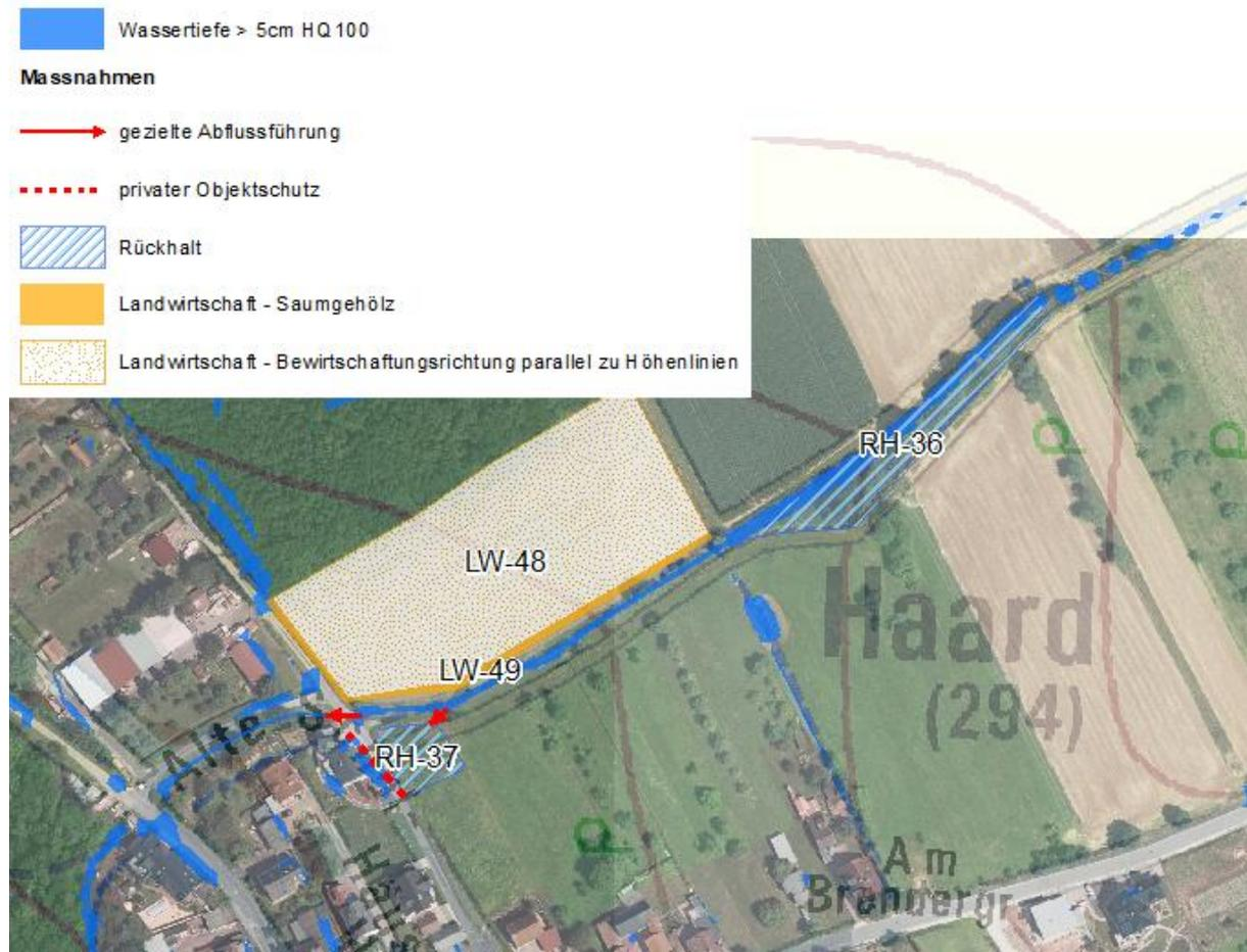
Abbildung 5-33: Abflusssituation in der nördlichen Ortslage Haard (HQ100) mit Maßnahmenvorschlägen
