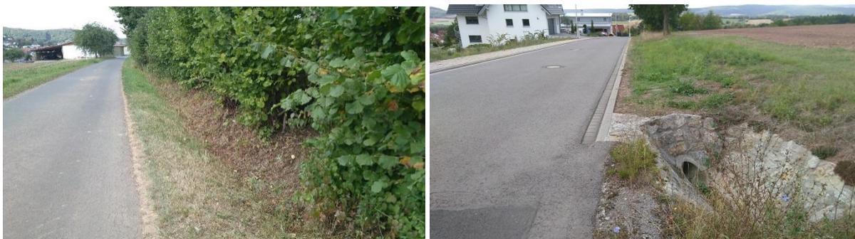
Abbildung 2-23: Straßen, die quer zur Hanglage verlaufen und somit einen Einfluss auf das topographisch bedingte Oberflächenabflussgeschehen haben können
