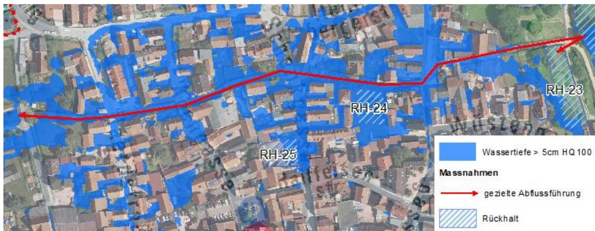
Abbildung 5-23: mögliche Flächen für einen gezielten Einstau und die gezielte Abflusslenkung auf dem Fußweg über der Verrohrung des Nüdlinger Baches
