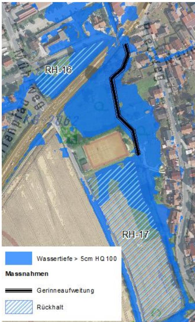
Abbildung 5-18: möglicher Rückhalt im Bereich Durchlass Riedbach unter Kissinger Straße / Gewerbegebiet Pfaffenpfad
