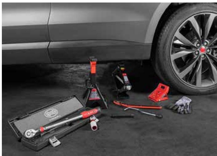
**Beim Reifenwechsel in Eigenregie sollten Sicherheit und Komfort nicht zu kurz kommen. Der rote Block etwa schützt das Fahrzeug vorm Wegrollen, mit dem Scherenwagenheber kann man es bequem anheben.**
